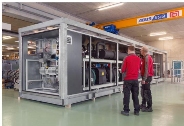
La machine au HFO robuste de CTA alimente le réseau de froid en fonction du mode de fonctionnement (froid de climatisation ou de processus) avec une eau froide de 16 °C ou 24 °C. Le générateur de froid dispose de trois gros compresseurs à vis d'une puissance frigorifique de 500 kW chacun. Chaque compresseur peut être réglé en continu entre 50 et 100 pour cent grâce à un convertisseur de fréquence, ce qui permet une coordination idéale des besoins en froid et de la production de froid.
